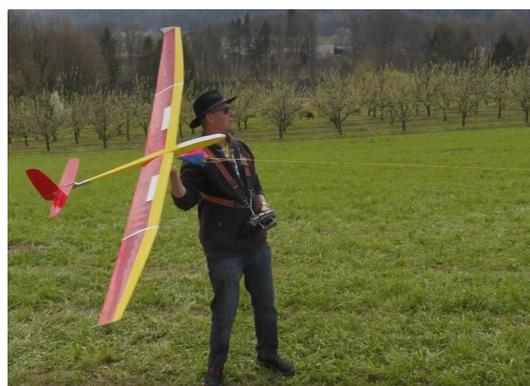
Au lâcher du planeur, l'énergie emmagasinée lui permet de monter sans vent jusqu'à 50 mètres et avec une légère brise d'atteindre les 90.
